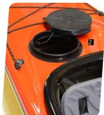
**2** Des weiteren besteht bei vielen Modellen die Möglichkeit, hinten auf dem Oberschiff eine zusätzliche Luke (Ø 150 mm, 200 mm oder 240 mm ) mit entsprechender Schottwand einzubauen.
